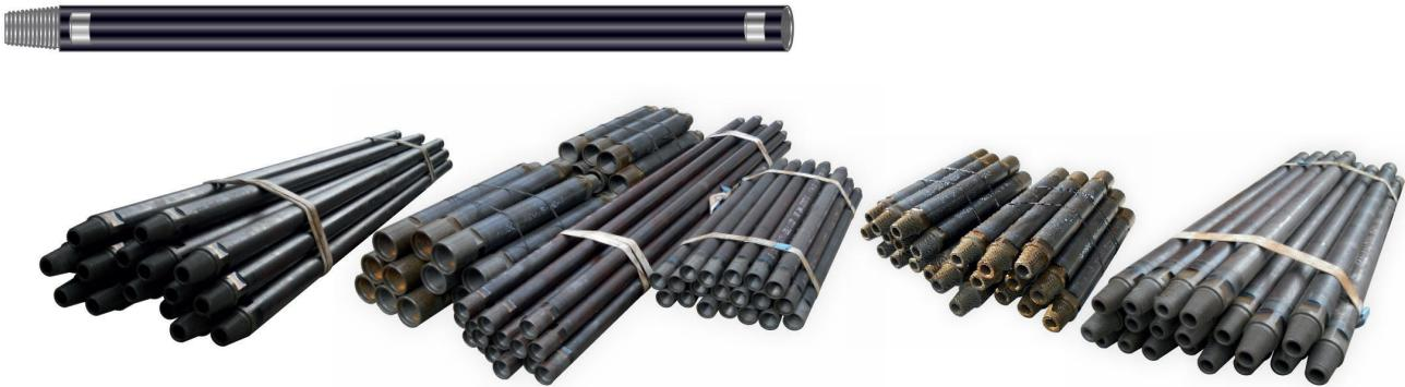
Le aste di perforazione sono prodotte da tubi senza saldatura, con manicotti trattati, lavorati da acciaio 42CrMo4 bonificato, con grado di durezza 285-320 BRINNELL. Tutti i manicotti sono accuratamente filettati secondo specifiche API, bonificati e sottoposti a trattamento anti-grippaggio. I manicotti sono saldati al tubo con processo di forgiatura a mezzo frizione.
