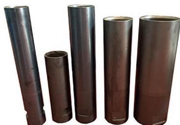
È un attrezzo usato per il recupero delle aste con azione autocentrante grazie alle sue pareti interne coniche, agisce ingaggiando la batteria sul diametro esterno. È necessario portare l'attrezzo a contatto della parte superiore della batteria da recuperare, appoggiare l'attrezzo applicando poco peso, ruotare finché la filettatura rastremata e carburizzata si aviti sul diametro esterno della batteria e quindi sollevare.
