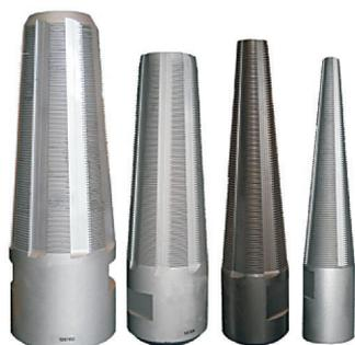
È il più semplice dei pescatori; serve ad agganciare la batteria persa nel pozzo sul diametro interno delle aste o degli astoni da recuperare. È necessario portare l'attrezzo sul foro della batteria di aste, applicare un leggero peso e ruotare sufficientemente fino a che la filettatura rastremata e carburizzata dell'attrezzo penetra nell'imboccatura del foro della batteria. Cessare quindi la rotazione e mettere in tiro la batteria.
