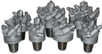
🇮🇹 Questi utensili sono ideali nell'attraversamento di marne, ghiaie, argille scagliose e in generale in tutte le formazioni mediamente consolidate. La punta pilota è avvitata al corpo; i picchi, montati su portapicchi in quantità crescente in funzione del diametro, sono sostituibili quando la punta di carburo di tungsteno è consumata.
