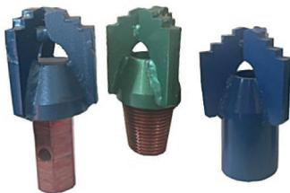
🇮🇹 Gli scalpelli a lame trovano ampio utilizzo in fori per jet grouting, pozzi per acqua e ricerche minerarie. Danno ottimi risultati nella perforazione di formazioni poco consolidate (argille-sabbie-marne etc.). Disponibili nel tipo «Step» (a gradini) o tipo «Chevron» (lame dritta).
