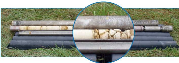
ESTRAZIONE DI UNA CAROTA DI TERRENO EXTRACTION OF A CORE
